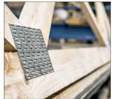
Die Elemente werden in einer Nagelplattenpresse dauerhaft mittels der Nagelplatten verbunden.
