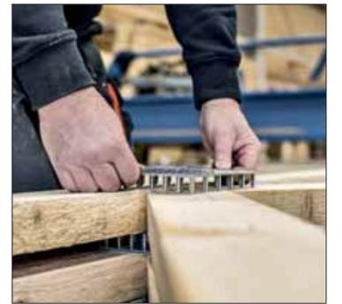
Die Einpresspunkte werden von den Mitarbeitern im Holzbauzentrum Sangerhausen millimetergenau definiert.
