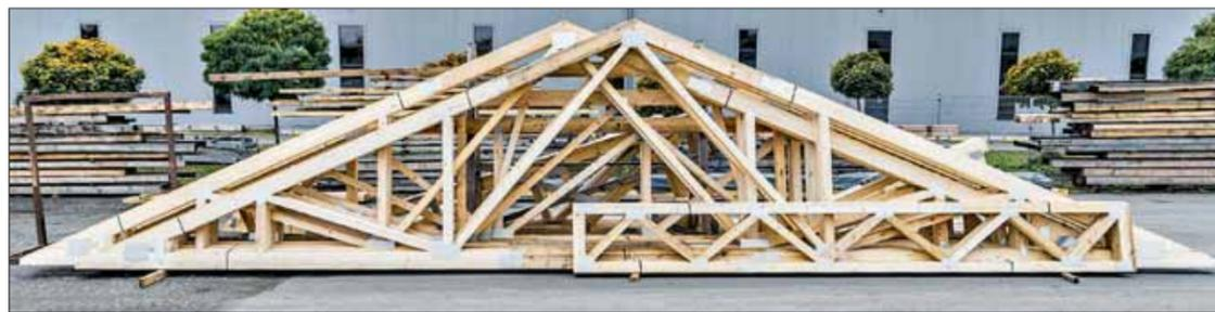
Zwei bis drei Tage nach Dateneingang vom Kunden ist die Nagelplattenkonstruktion fertig produziert.
