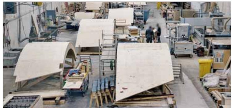
Die werkseitige Vorfertigung der Dachelemente in Aichach erfolgte in sechs Arbeitsschritten bis zur Verklebung der Abdichtungsbahn auf der Elementoberseite.
